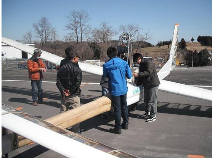
平日の事もあり、トレーニングもビジターもなさそう。早速機体を滑走路に据えて試験開始です。600mの滑走路はやはり長い！仮に少しぐらい浮いても何の心配もない。ただし横風だけは容赦無く吹き続けています。エルロンがあれば十分対処できるコンディションながら、SP-1は『上反角+ラダー』機。横風で直進滑走するのは限界がある。どうしても走路の中央から逸れてパワーオフを強いられます。ひとまず前回の試験で泣いた前脚シミは解消したようだ。
