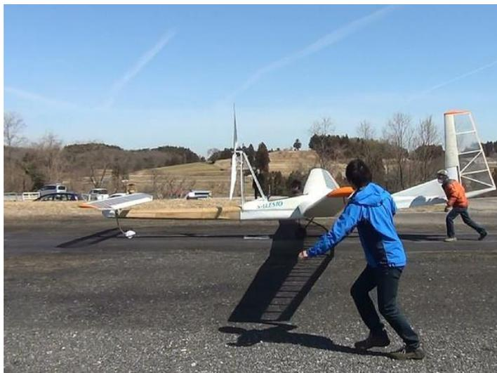
調整を繰り返す内、風も徐々に息をつく様子。滑走開始の軸線を風上に取り、走行中のバンクを抑える作戦で滑走速度が乗ってきました。時折強まる横風に、パイロット判断で少し浮かせます。飛行機は空中の方がずっと自由が利くため、適切な判断です。偏流角も決まり滑走路をきれいなぞっていく SP-1。これまで何度もバンジーで飛行した経験が確実に生きている。
